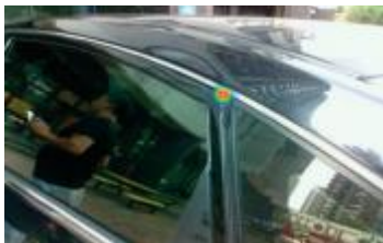
缝隙密封问题:将导致漏水
