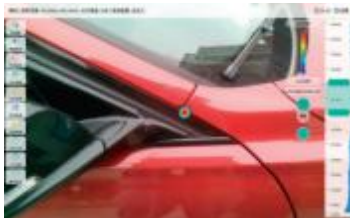
缝隙密封问题:将导致漏水
